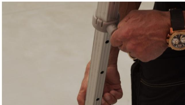
Wenn Sie auch Seitenwände einhängen möchten, müssen Sie den Bolzen in das oberste Loch einrasten lassen.
